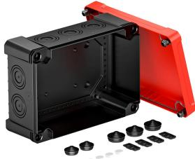
Boîtier de dérivation pour le raccordement des câbles et conduits en intérieur et en extérieur. Forme rectangulaire avec entrées défonçables. Convient pour le montage mural/au plafond avec possibilité de fixation intérieure, extérieure ou de montage sur les dômes angulaires. Particulièrement résistant aux chocs avec IK09. Couvercle avec fermeture rapide, plombable. Fabriqué à partir de matériaux sans halogène et résistants aux UV.
