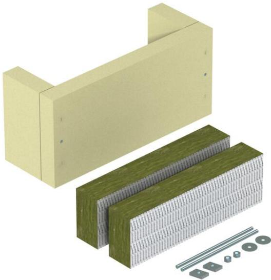
Décharge de traction comme mesure efficace pour pose de câbles verticale selon DIN4102 partie 12, homologuée pour tout type de câbles et tous les systèmes de pose verticaux. Classes de maintien en fonction E30 à E90. Boîtier avec plaques en fibres minérales, matériel de fixation, cartouche avec enduit coupe-feu ASX et plaque d'identification.
