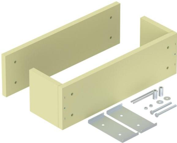
Décharge de traction comme mesure efficace pour pose de câbles verticale selon la norme DIN 4102 partie 12. Homologation pour tout type de câbles et échelles verticales en montage suspendu. Classes de maintien en fonction E30 à E90. Boîtier vide pour remplissage individuel avec la mousse coupe-feu PYROSLIT® NG et/ou les blocs de mousse PYROPLUG® Block, y compris kit de montage et plaque d'identification.
