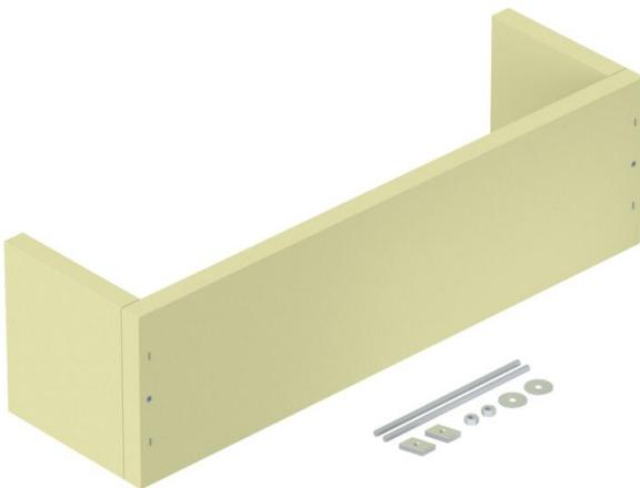
Décharge de traction comme mesure efficace pour pose de câbles verticale selon la norme DIN 4102 partie 12. Homologation pour tous les types de câble et systèmes de pose qui sont posés directement sur les parois massives. Classes de maintien en fonction E30 à E90. Boîtier vide pour remplissage individuel avec la mousse coupe-feu PYROSIT® NG et/ou les blocs de mousse PYROPLUG® Block, y compris kit de montage et plaque d'identification.
