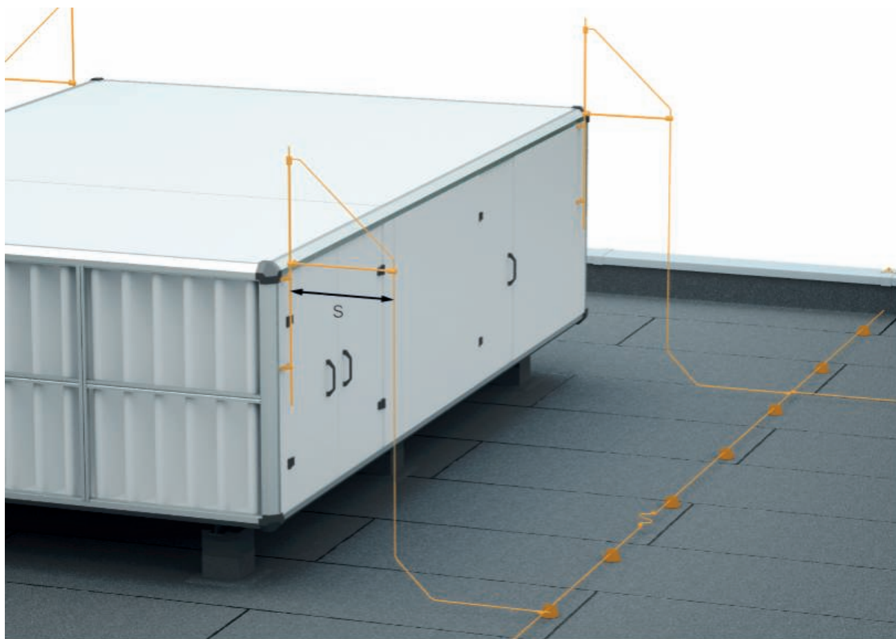
Correct aangehouden scheidingsafstand (s) afleidingsinrichtingen en dakelementen
