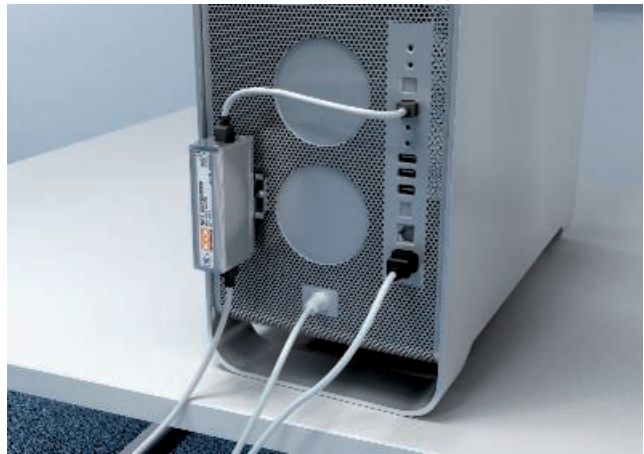
Beveiligingsvoorstel aan eindapparaat Om het beveiligingsniveau laag te houden, gebruikt de overspanningsbeveiliging als PE-verbinding de randarde van de PC-behuizing.
