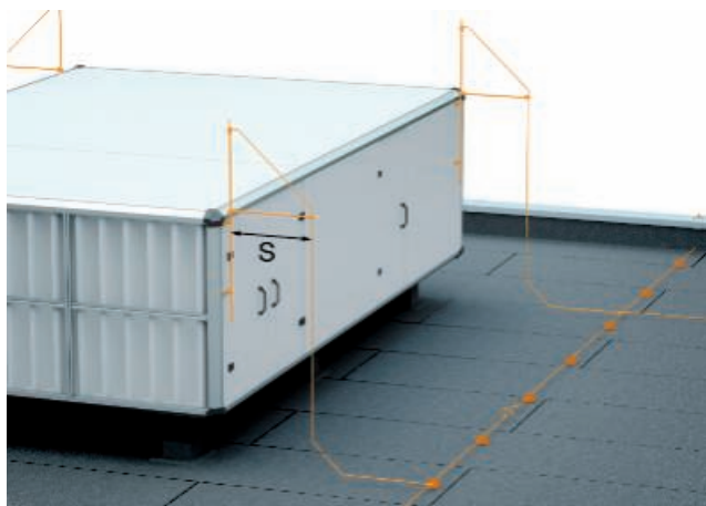
Voorbeeld: opvangsysteem met Iso-Combi-set voor driehoeksbevestiging
