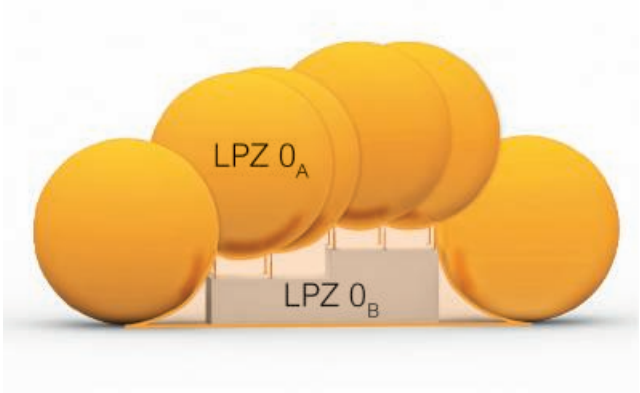
Bliksembolmethode en resulterende bliksembeveiligingszones (LPZ)
