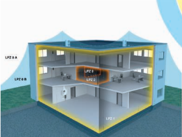
Beveiligingsprincipe conform het concept van bliksembeveiligingszones
