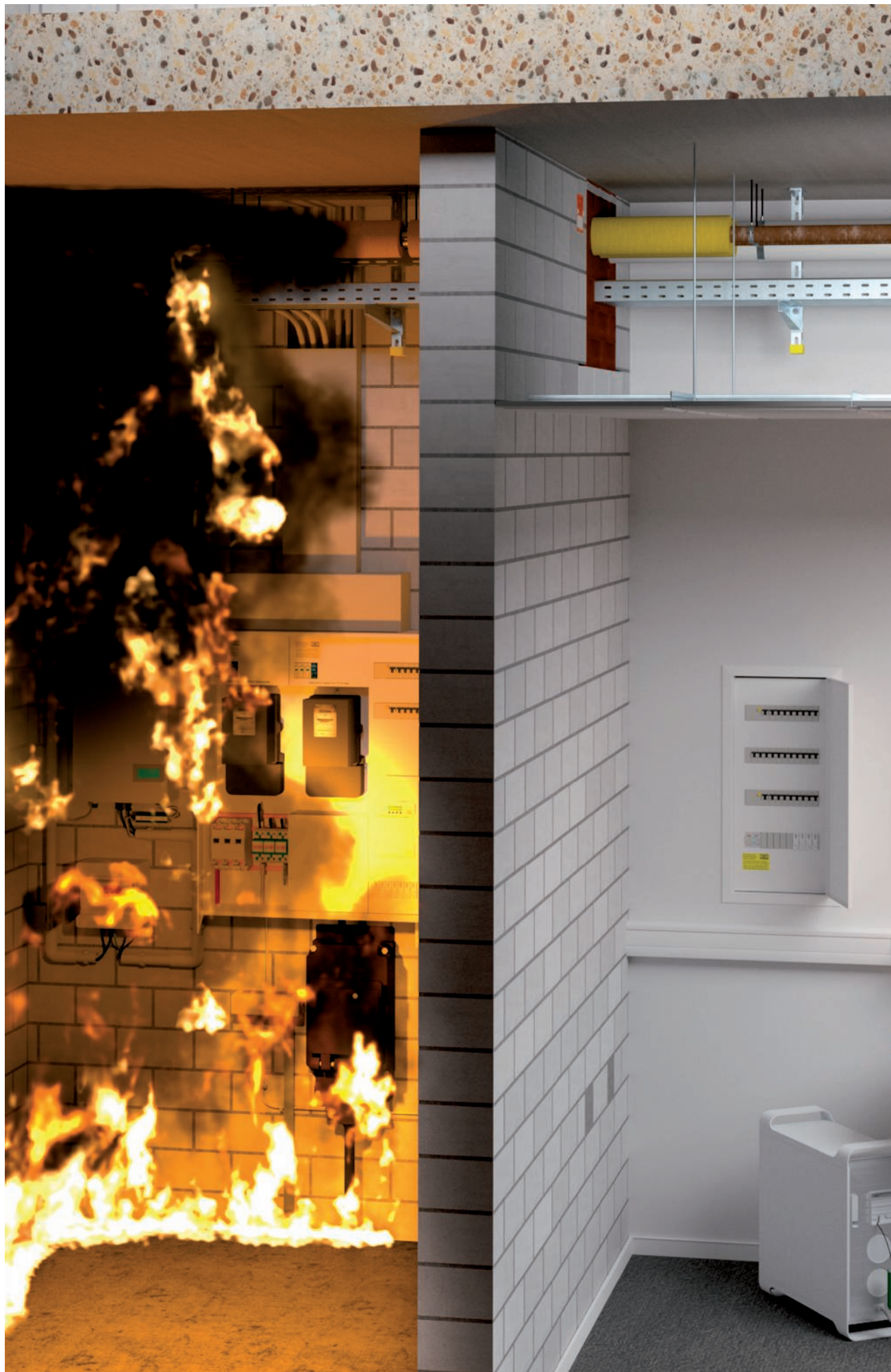
Plafond- en wanddoorvoeren kunnen betrouwbaar tegen brand en rook worden afgedicht.
