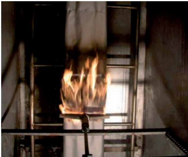
Beproeving van de kabelbandage
