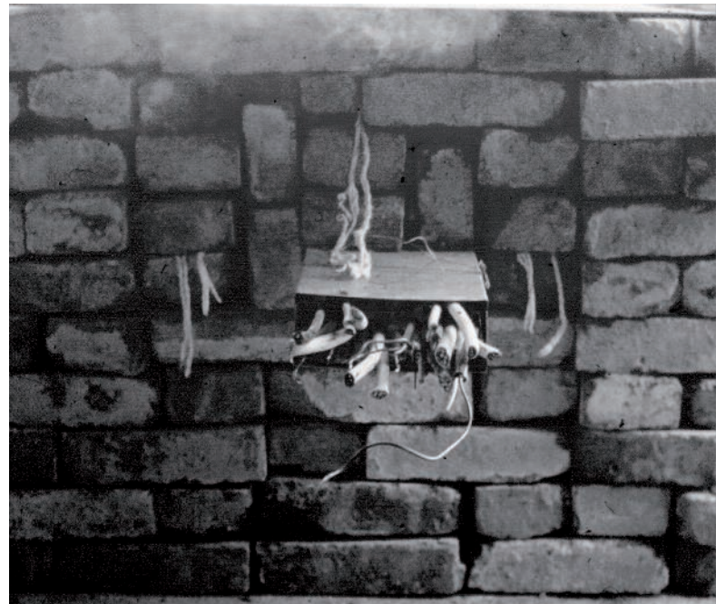
Testopstelling van de eerste brandwerende kabeldoorvoer van OBO
