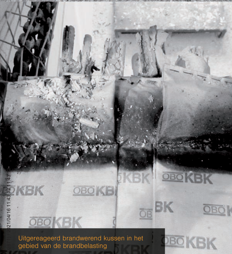
Simulatie van het reactiegedrag van brandwerend doorvoer-materiaal
