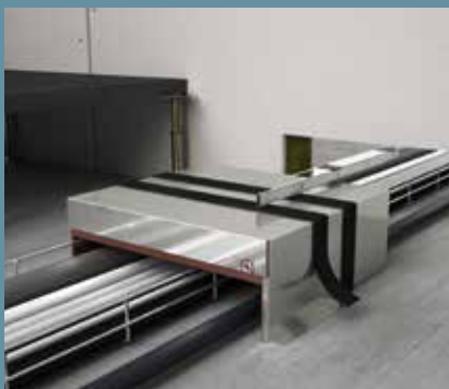
Wanddikte meten en grafietstrips op passende afstand aanbrengen
